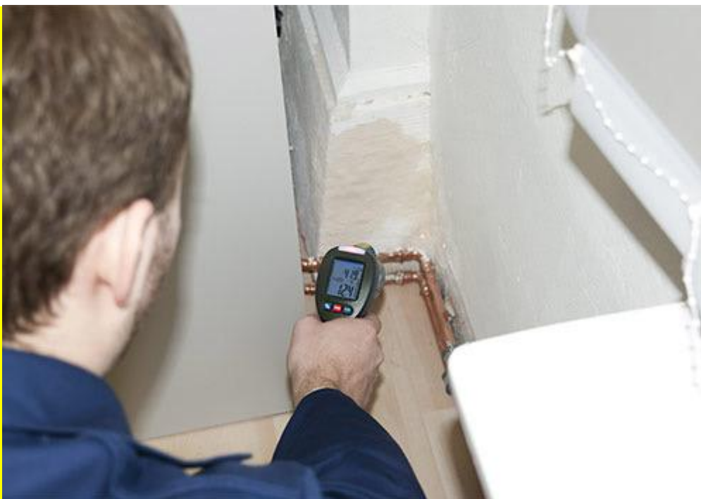
De dauwpuntscanner bij het onderzoek van de muren van een oud gebouw.
