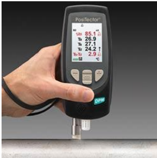
Dauwpuntmeter PT-DPM met alarmindicaties
