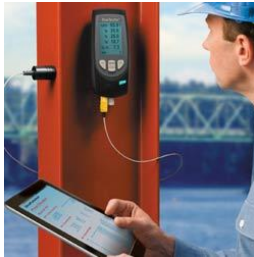
Dauwpuntmeter PT-DPM met externe temperatuursensor
