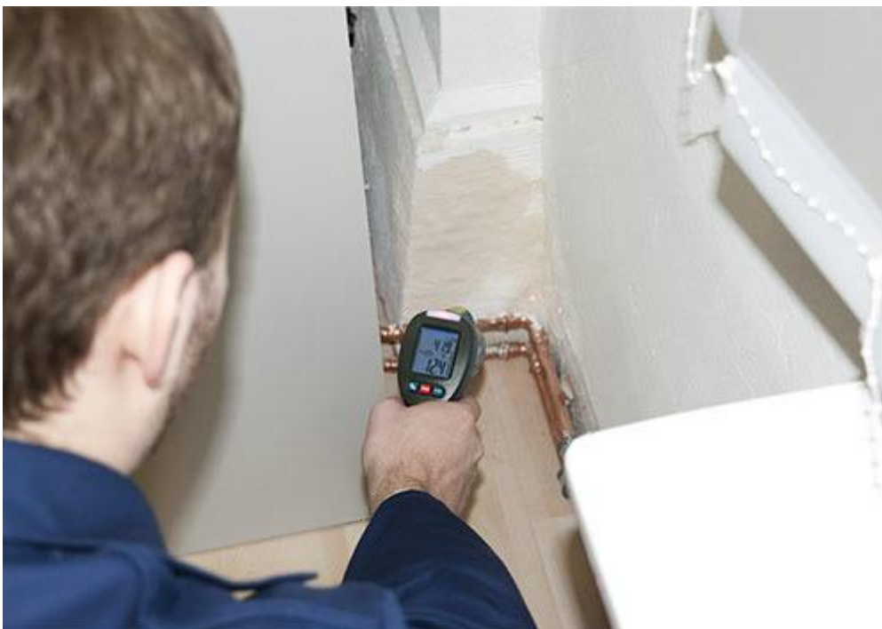
De dauwpunt temperatuurmeter bij het onderzoek van de muren van een oud gebouw.
