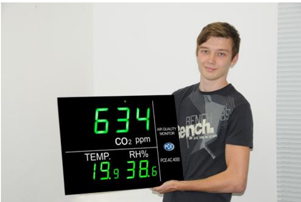
Hier wordt de CO 2 -meter PCE-AC 4000 aan de muur opgehangen.
