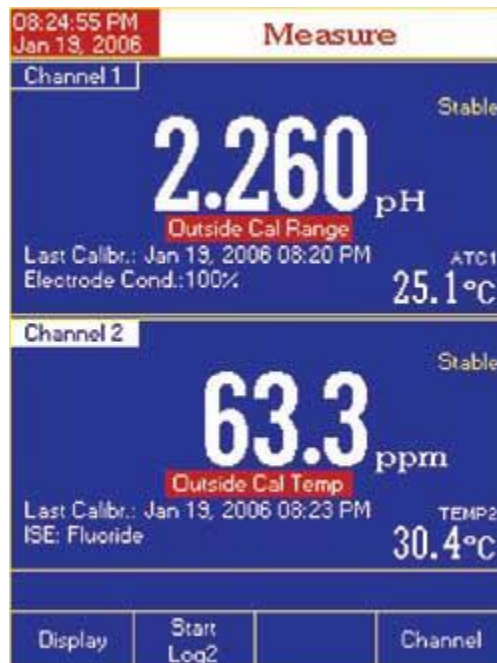
Universele laboratorium pH-meter HI 4222-02, Tweekanale weergave
