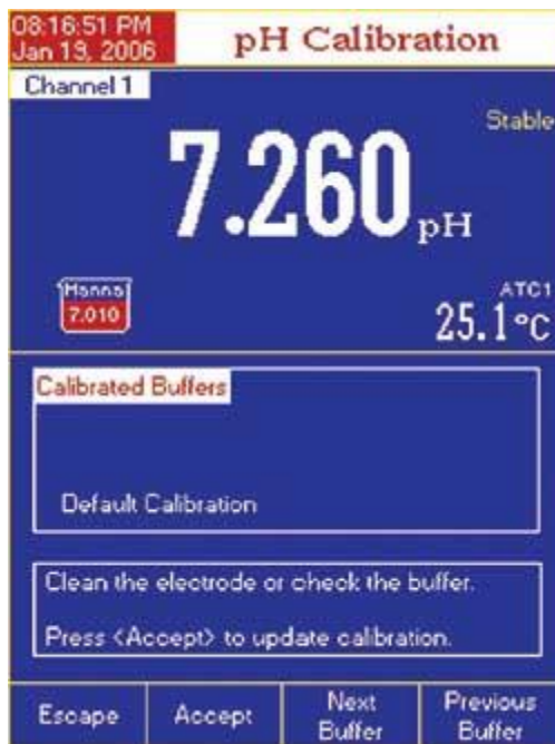
Universele laboratorium pH-meter met display aanwijzing van elektrode reiniging
