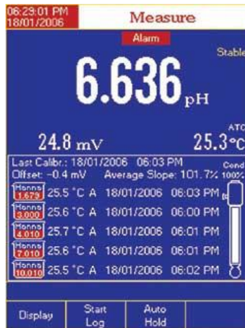
Universele laboratorium pH-meter met display opmerking voor de noodzakelijke herijking
