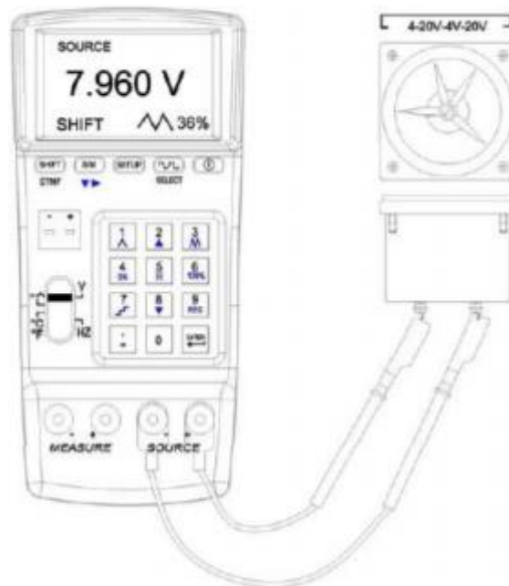
Aansluiting kabels voor snelle scan
