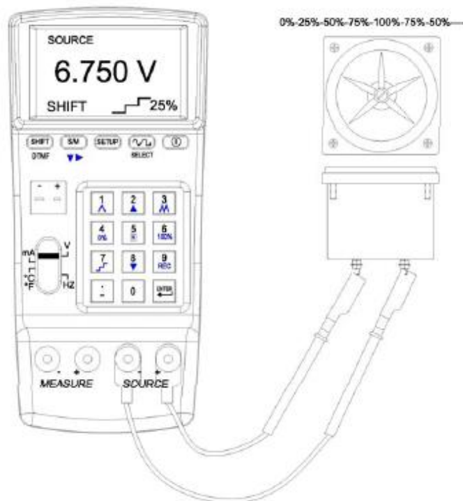
Aansluiting kabels voor Multi-step scan
