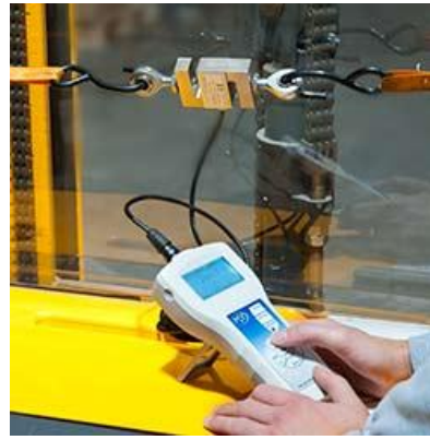
Precisie krachtmeter PCE-FB K met externe load cell voor druk- en trekkrachten.
